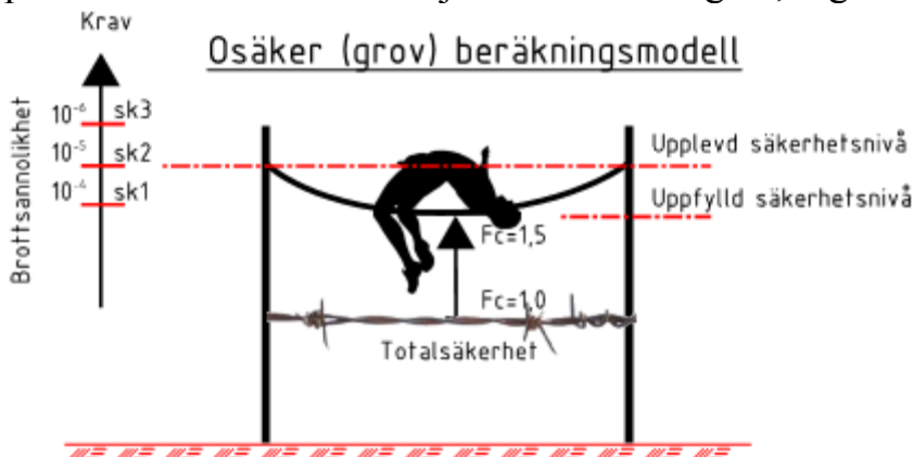
Figur 4: Upplevd säkerhetsnivå vs uppfylld säkerhetsnivå med en grov beräkningsmodell.
