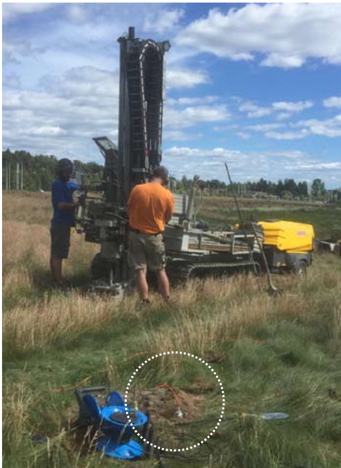
Figur 5. Seismiska mätningar i Åkersberga med triaxiell geofon och triaxiell accelerometer på 4 m avstånd från borrhölet.
