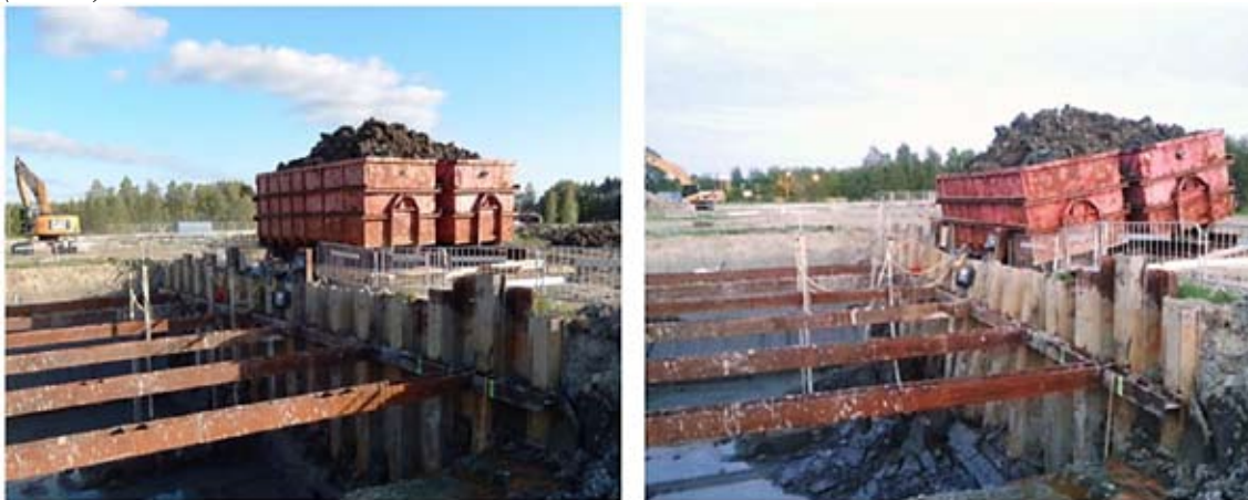
Figur. 7: (a) Sista laststeget avslutat, Test 1; (b) Bild efter brott i konstruktionen, Test 1
