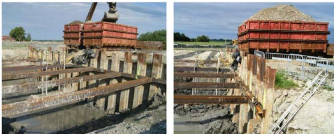
Figur. 8: (a) Sista laststeget påförs, Test 2; (b) Bild efter brott i konstruktionen, Test 2
