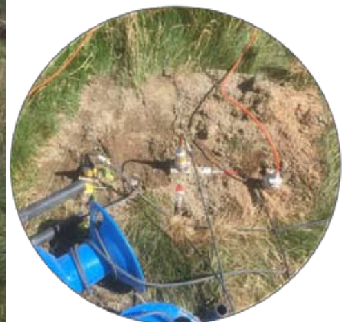
Figur 5. Seismiska mätningar i Åkersberga med triaxiell geofon och triaxiell accelerometer på 4 m avstånd från borrhölet.
