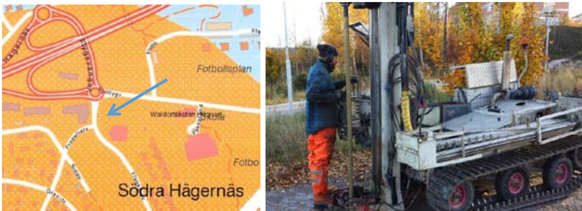
Figur 6. Geologisk karta över undersökningsområdet Hägernäs; för Jb-sondering användes en bormaskinen av typ Geotech.
