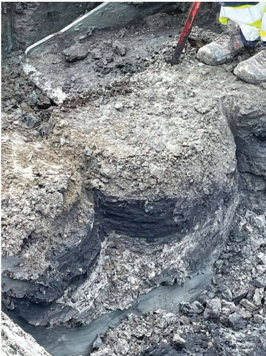
Figur 16 Framschaktade pelare i fält.
