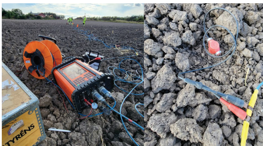
Figur 4 Seismograf Terraloc med 4,5Hz geofoner på delsträcka 5.
