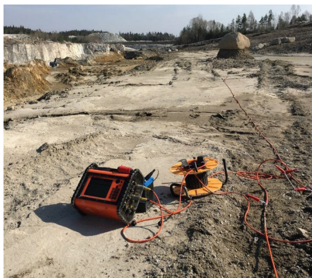
Figur 6. Använd fältutrustning, Terrameter LS2 från Guideline Geo med tillhörande 5 m kabelsystem. En komplett konfiguration med 4 inkopplade kablar ger en 400 m lång undersökningslinje. Genom att flytta fram den första kabeln efter varje mätning kan undersökningslinjen förlängas obegränsat.
