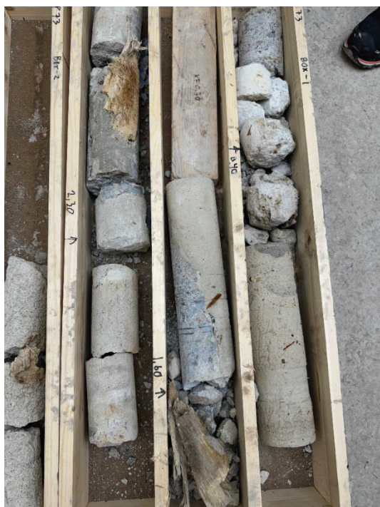
Figur 4-2: Kärnprover visar t.ex. anslutningen mellan jetinjektering och de gamla träpålarna
