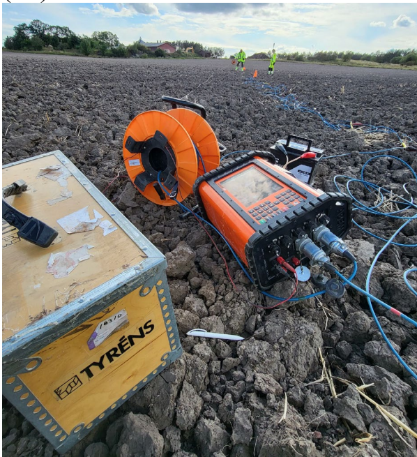
Figur 2. Seismografen och mottagarsystemet i fält.
