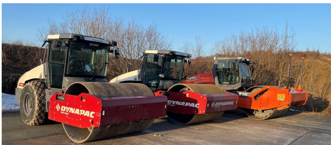
Figur 9 Vältar för packningsförsök: Dynapac CA4000D Seismic, Dynapac CA6500D Seismic och Hamm H25i.
