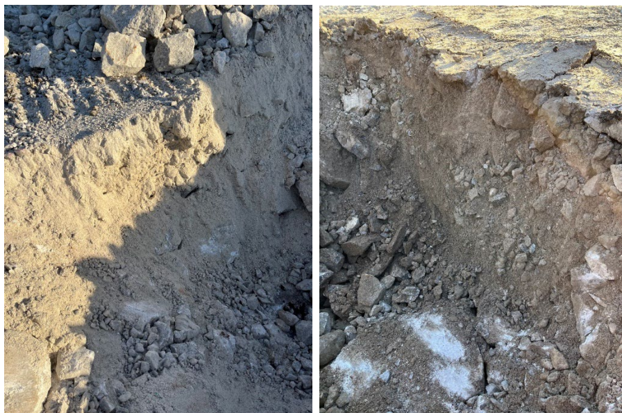
Figur 8 Nedkrossning efter packning (vänster: tonalit, höger: kalkglimmerskiffer).
