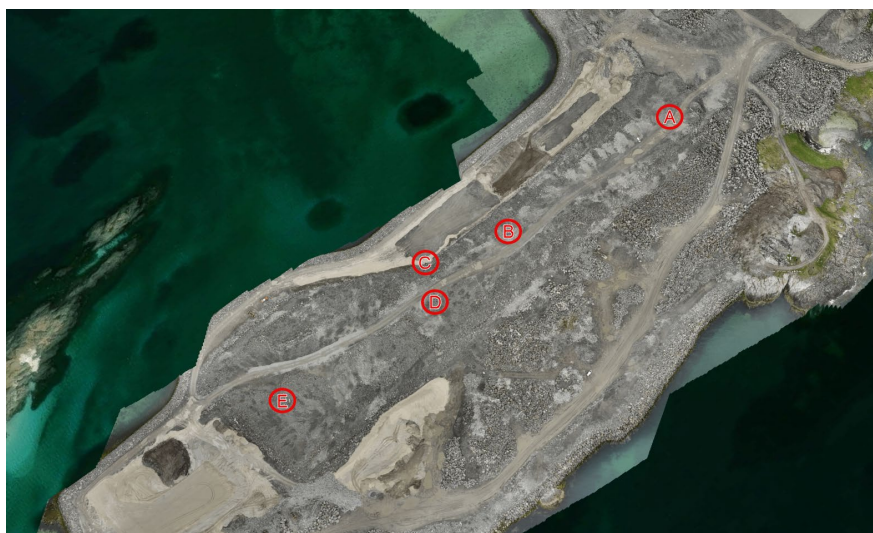
Figur 18 Drönarfoto över sjöfyllning och placering av sättningsmätning.
