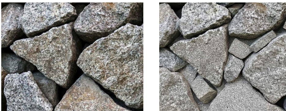
Figur 7. Vänster: en fyllning med få kontaktpunkter och stora lokala spänningar, höger: en nedbruten fyllning med fler kontaktpunkter och lägre lokala spänningar. Genererat med AI (Google Gemini).
