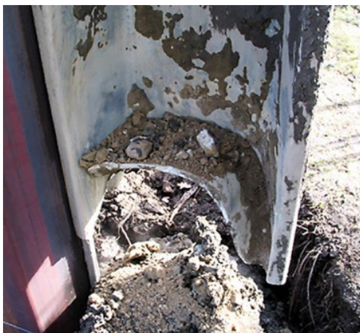
Figur 1. En fördärvad spontfot som följd av kollisionsdrivning (Foto: Kenneth Viking).
