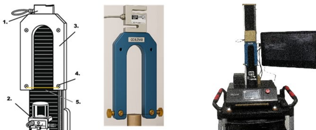
Figur 2: Huvudkomponenter: 1) lastcell, 2) provhållare, 3) CCT-gaffel, 4) trådinspännare, 5) linjärstyrning. Till höger visas den kompletta utrustningen.
